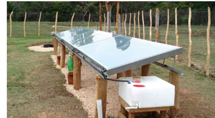
Aufbau und Installation von solaren Trinkwasserreinigungsanlagen an der Mündung des Rio Maximo für die Cooperative Fauna und Flora.
